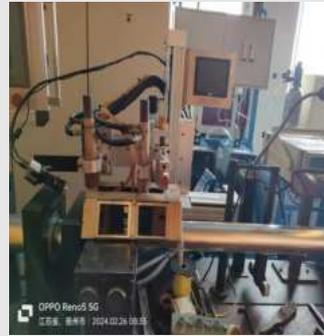
改造后的超高压氩弧焊管机无氦焊接
